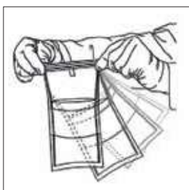
KROK 5A Trzymaj woreczek za uchwyt i zakręć 3 do 4 razy, aby uzyskać uszczelnienie.
